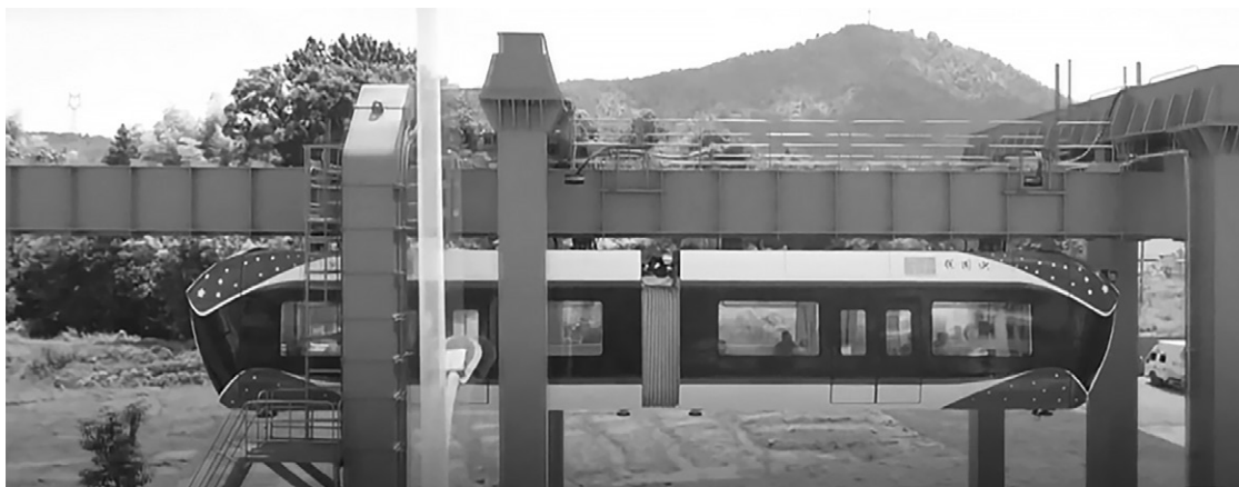
Рисунок 1. Подвесной маглев на постоянных магнитах в китайском городском округе Гуаньчжоу
