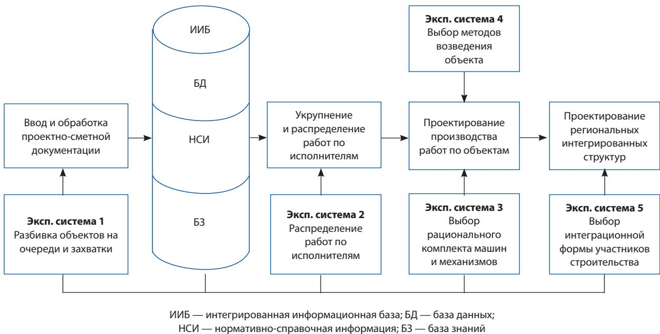
**Рисунок 3.** Поддержка решения задач организации и управления строительным производством с помощью экспертных систем
