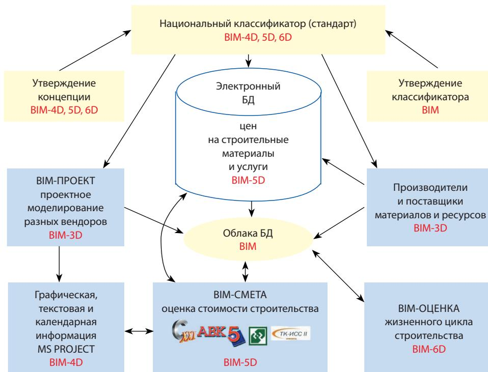
**Рисунок 1.** Схема единой информационной платформы — основного инструмента для создания BIM-модели
