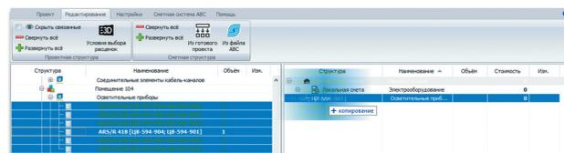
Рисунок 21. Перенос элементов из проектной структуры в смету (рекомпозиция)
